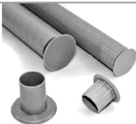
En matière plastique. Adaptés aux tuyaux d'un  $\varnothing$  intérieur de 22 mm. Utilisation comme l'obturbateur normal. Après le décoffrage cet obturbateur sera monté sur le tuyau. Couleur: gris (béton).
