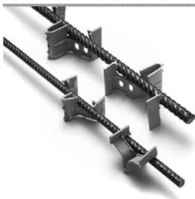
«Le taquet d'armature posé contre des plaques isolantes» en matière synthétique à haute résistance aux chocs. Le taquet stable soutient avec sa grande surface d'appui les armatures en cas de dalles et de parois isolés. Pour aciers d'armature jusqu'à 18 mm de diamètre. Le même taquet pour deux écartements, 15 mm et 20 mm ou 25 mm et 30 mm. Couleur gris. Couleurs spéciales avec augmentation de prix. Quantités minimum 5000 pcs.
