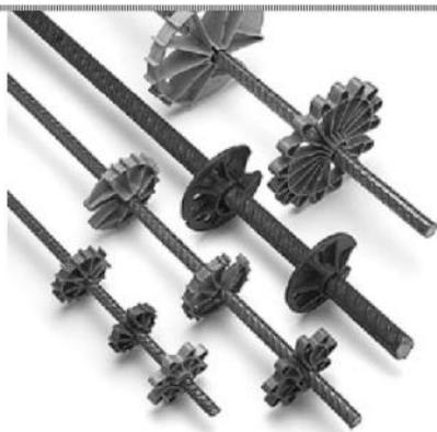
En matière synthétique à haute résistance aux chocs. Les taquets pour les armatures des piliers et des parois. Grâce à leurs faible surface d'appui, ils conviennent particulièrement bien pour les bétons apparents. Exécution plus robuste pour les aciers d'armatures de gros diamètres. Grand choix pour écartements entre 10 et 50 mm, pour les aciers d'armature d'un diamètre entre 4 et 44 mm.
